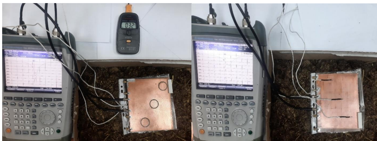
Рис. 3.16 – Экспериментальное измерение комплексной диэлектрической проницаемости и температуры конского навоза
