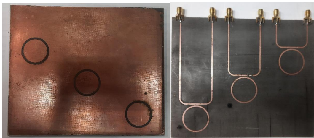
Рис. 3.12 – Двухслойная структура датчика
