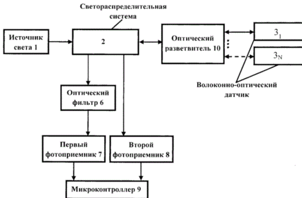
Рис. 3.18 – Структурная схема многосенсорной системы измерения температуры, на основе АВБР
