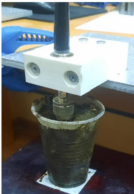
Рис. 2.6 – Измерение комплексной диэлектрической проницаемости птичьего помета методом коаксиального пробника
