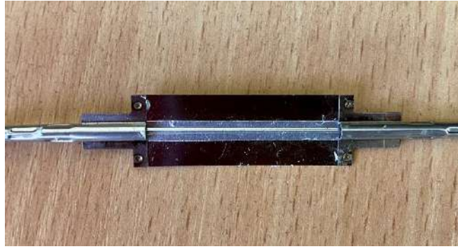
Рисунок 4.17 – Внешний вид датчика температуры на основе АВБС
