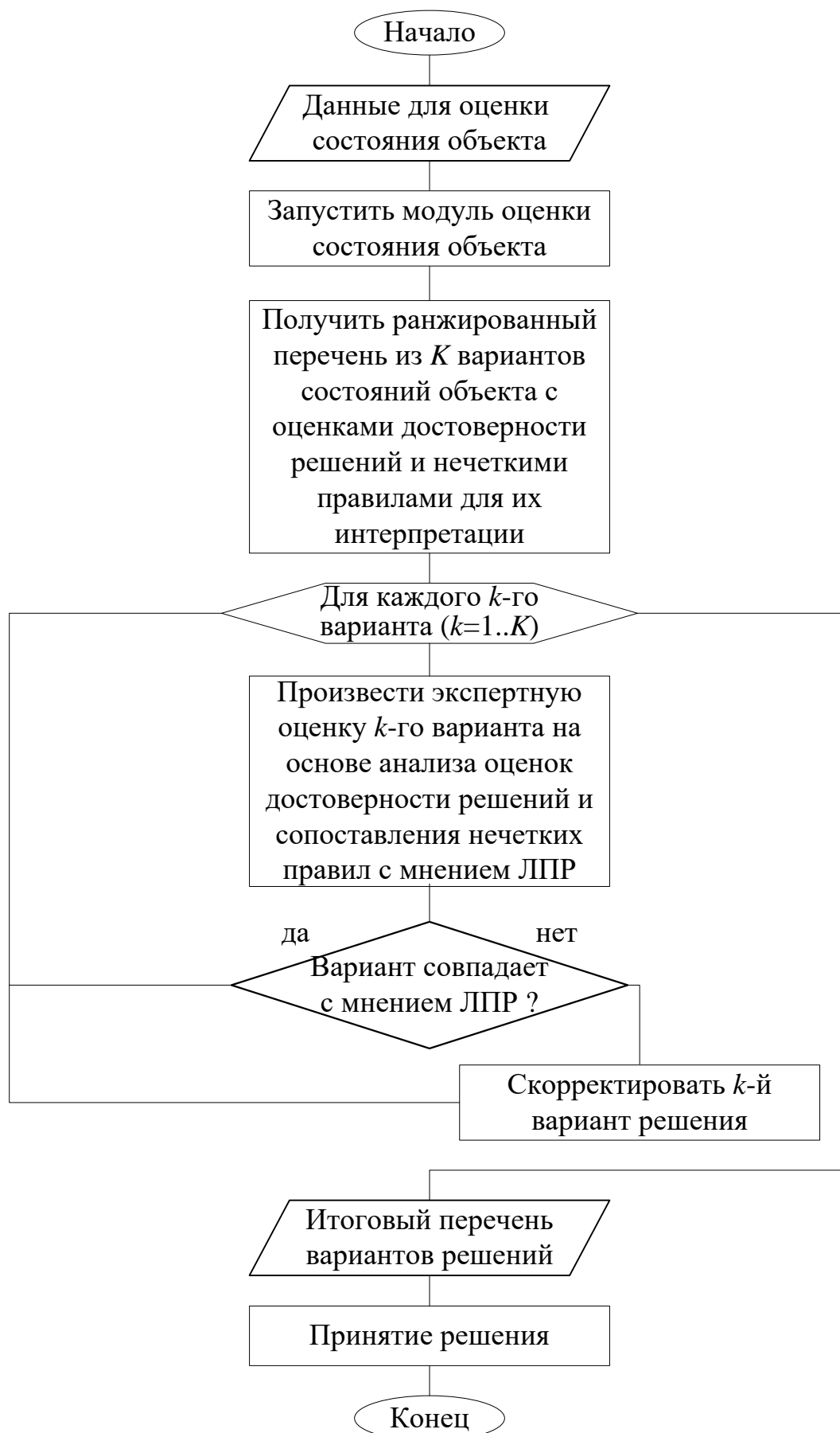
Рисунок 4.14 – Блок-схема алгоритма поддержки принятия решения по оценке состояния объекта
