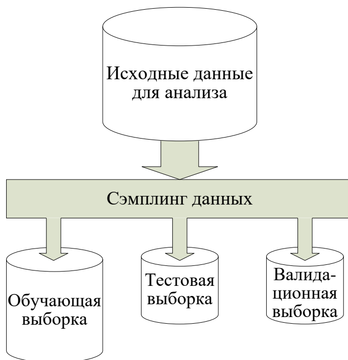
Рисунок 2.5 – Схема формирования выборок данных для построения и оценки адекватности нейронечеткой модели
