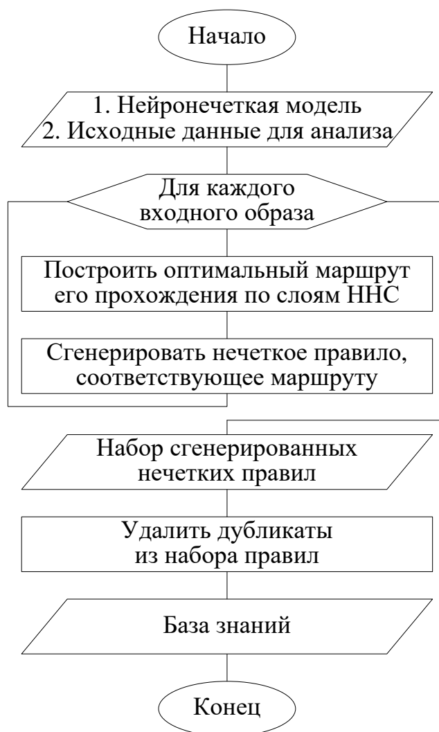
Рисунок 3.18 – Блок-схема алгоритма формирования базы знаний на основе построенной нейронечеткой модели
