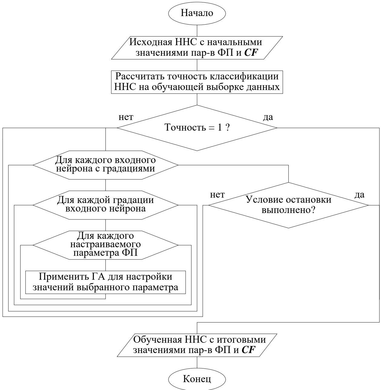
Рисунок 3.11 – Блок-схема работы алгоритма обучения нечеткой нейронной сети
