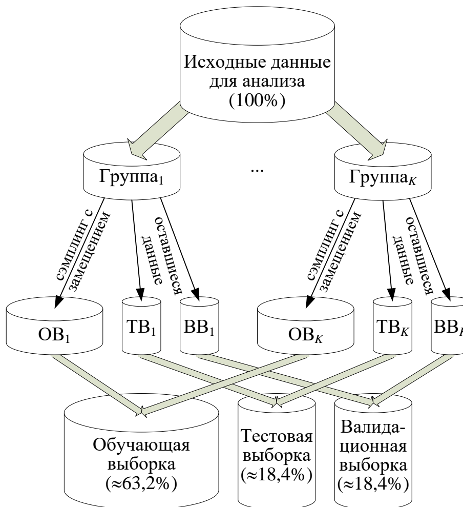
Рисунок 3.1 – Схема разработанного метода сэмплинга данных
