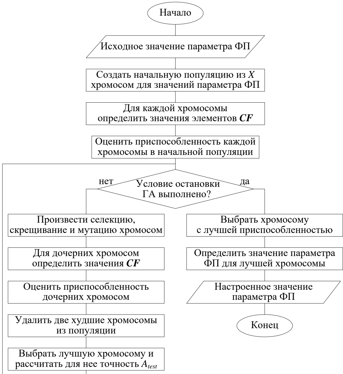
Рисунок 3.10 – Блок-схема работы генетического алгоритма
