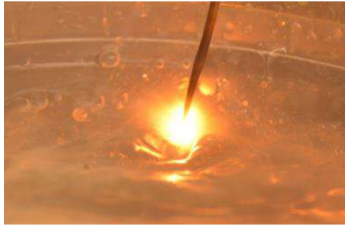
Рисунок 3.11 - Момент инициирования разряда методом приведения в контакт анода с поверхностью электролита, температура электролита 50°C.
