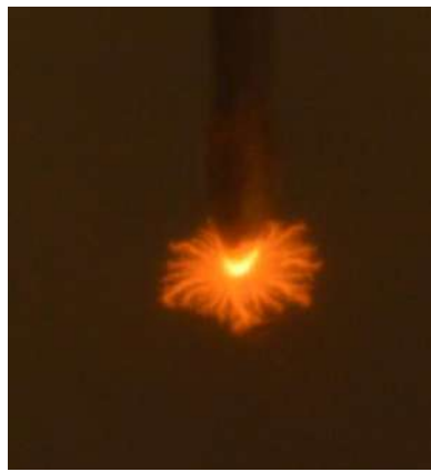
Рисунок 3.12 - Лидерная структура газового разряда на поверхности электролитического катода NaOH .
