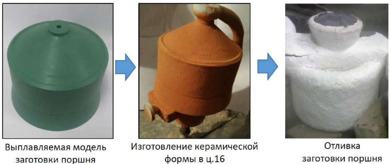
Рисунок 4.1 - Изготовление детали при литье по выплавляемым моделям
