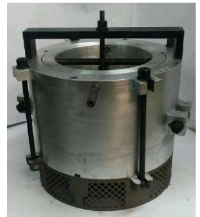
Рисунок 4.6 - Пресс-формы, изготовленные с использованием селективного лазерного сплавления
