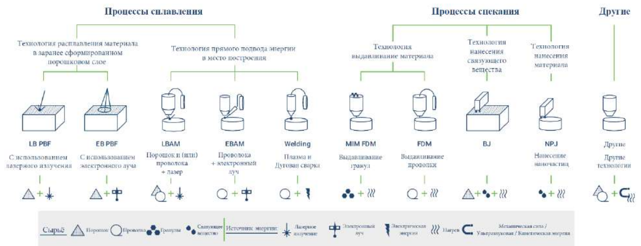
Рисунок 1.1 – Виды аддитивных технологий производства из металлов и сплавов [1].
