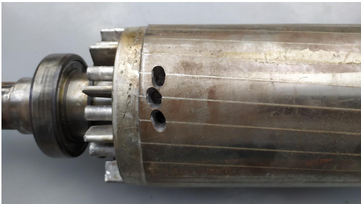
Рисунок 4.4 – Ротор с просверленными отверстиями. Два стержня сломано
