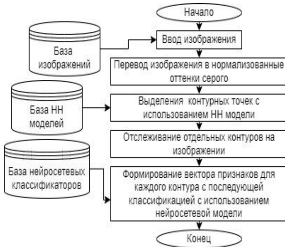
Рис. 4.2 – Схема последовательности использования Баз: нейронечетких моделей и нейросетевых классификаторов для распознавания объекта на изображении
