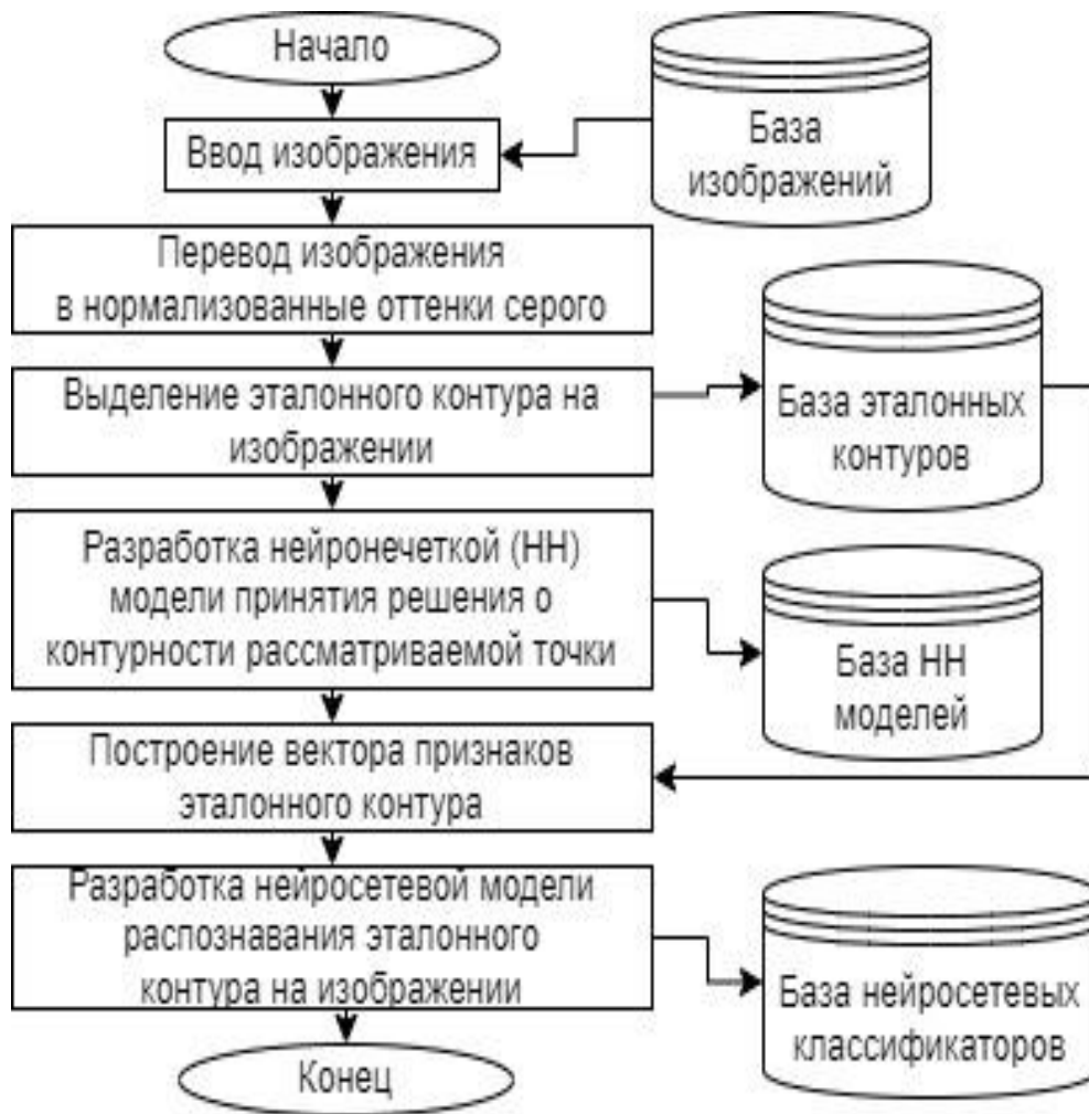
Рис. 4.1 – Схема последовательности формирования Баз: эталонных контуров, нейронечетких (НН) моделей, нейросетевых классификаторов
